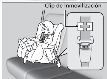
6. Asegúrese de que el sistema de sujeción para niños esté firmemente sujeto; para ello, balancéelo hacia adelante, hacia atrás y a los lados; debe percibirse un movimiento mínimo.
