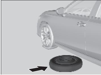
**6.** Coloque el neumático compacto de repuesto (con la llanta hacia arriba) debajo del vehículo, cerca del neumático que va a sustituir.
