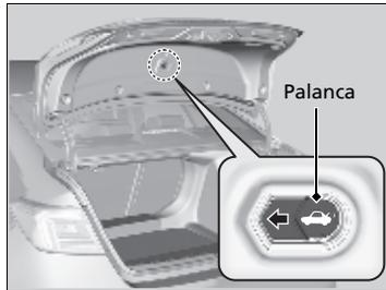
La palanca de apertura del maletero permite abrir el maletero desde el interior para su seguridad.
