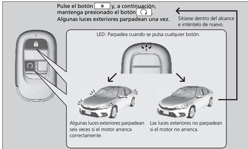
Cuando se arranca de forma remota, el motor se apaga automáticamente tras 10 minutos en ralentí o si no se ha pisado el pedal de freno a la vez que se ha presionado el botón **ENGINE START/STOP**.
