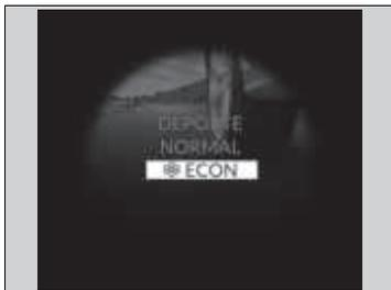
Ayuda a mejorar el consumo de combustible ajustando el rendimiento del motor, la transmisión, el sistema de aire acondicionado y el control de crucero.
