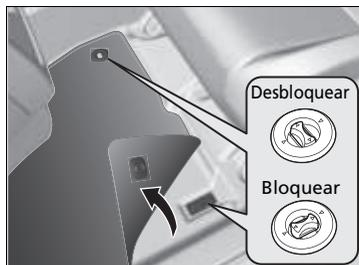
La alfombra del piso del conductor queda enganchada por encima de los anclajes del piso, lo que impide que se deslice hacia delante. Para desmontar una alfombra para limpiarla, gire los control del anclaje a la posición de desbloqueo. Cuando vuelva a montar la alfombra después de limpiarla, gire los control a la posición de bloqueo.
