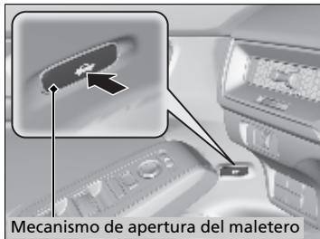
Mantenga presionado el mecanismo de apertura del maletero en la puerta del conductor para desbloquear y abrir el maletero.
