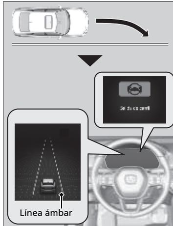
La cámara delantera detrás del espejo retrovisor controla las marcas de carril izquierdo y derecho en blanco o amarillo, y el borde exterior de la carretera (hacia una cuneta de hierba o gravilla) o de vehículos que se aproximan y que se han detectado. Si su vehículo se aproxima a una marca de carril detectada, el borde exterior de la carretera (con una cuneta de hierba o gravilla) o se detectan vehículos que se aproximan sin haberse activado los intermitentes, el sistema se activa.
