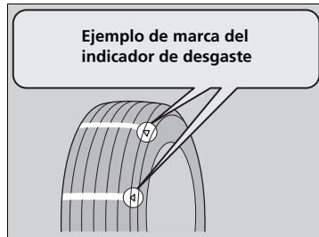
La ranura en la que está situado el indicador de desgaste es aproximadamente 1,6 mm más profunda que cualquier otro punto del neumático. Si la banda está desgastada y el indicador queda visible, sustituya el neumático.
