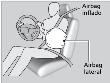
Cuando los sensores detectan un impacto lateral de moderado a fuerte, la unidad de control envía una señal al airbag lateral del lado que ha sufrido el impacto para que se infle de inmediato.
