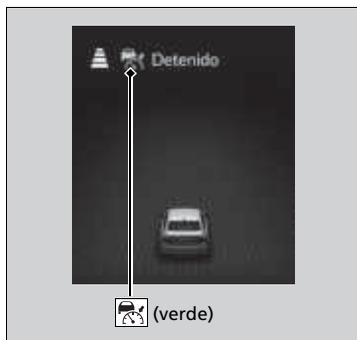
Si no tiene ningún vehículo delante antes de reanudar la conducción, pise el pedal del acelerador y el ACC con seguimiento de baja velocidad volverá a funcionar con la anterior velocidad programada.
