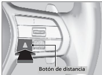
Pulse el botón de distancia para cambiar el intervalo de seguimiento del ACC con seguimiento de baja velocidad.
