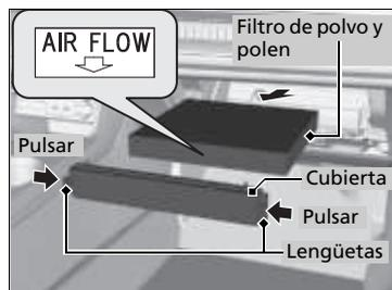
5. Presione las lengüetas de las esquinas de la cubierta de la carcasa del filtro y retire la cubierta.
