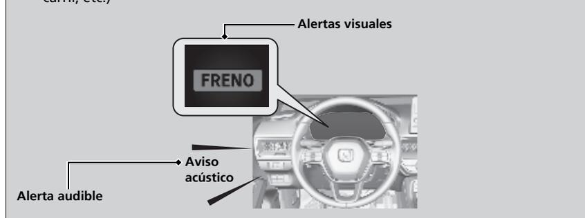
Puede cambiar la distancia (**Alejado/Normal/Cercano**) entre vehículos a la que se activa la alerta de colisión más temprana del sistema a través de las opciones de configuración de la pantalla del sistema de audio/información.
