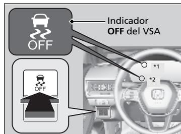
Este botón se encuentra en el panel de botones del lado del conductor. Para desactivar parcialmente la función/características de VSA, mantenga presionado hasta que escuche un aviso acústico.
