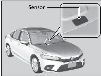
El sistema de control del aire acondicionado automático cuenta con diferentes sensores. No los tape ni vierta líquidos sobre ellos.
