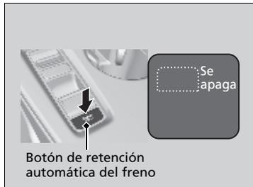
Mientras el sistema está encendido, pulse de nuevo el botón de retención de freno automática.
