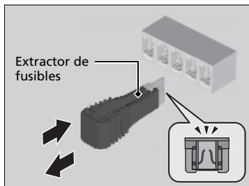
4. Compruebe los fusibles combinados de la caja de fusibles del compartimento motor.
