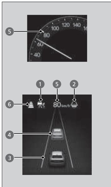
Puede ver el estado actual del control de crucero adaptativo (ACC) con seguimiento de baja velocidad y el sistema de asistencia de permanencia en carril (LKAS).
