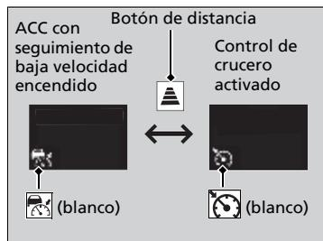
Mantenga presionado el botón de distancia durante un segundo. Aparece **Modo de crucero seleccionado** en la interfaz de información del conductor durante dos segundos y, a continuación, el modo cambia a crucero. El indicador se enciende.
