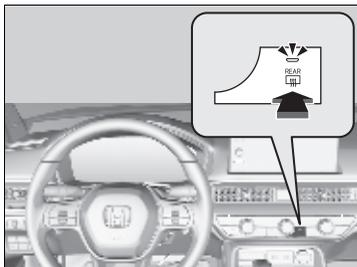
El desempañador trasero se desactiva automáticamente transcurridos de 10 a 30 minutos, en función de la temperatura exterior. Sin embargo, si la temperatura exterior es de 0°C o inferior, no se desconecta automáticamente.
