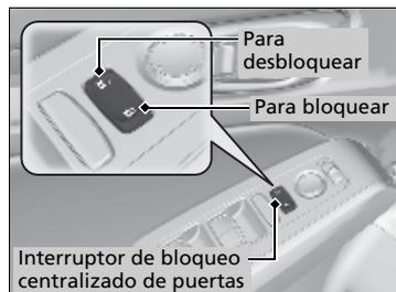
Pulse el interruptor de bloqueo principal de las puertas hacia dentro como se muestra para bloquear o desbloquear todas las puertas y la tapa del depósito de combustible.
