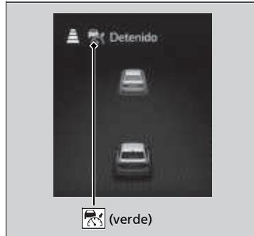
Su vehículo también se detiene automáticamente. El mensaje **Detenido** aparece en el indicador. Cuando el vehículo que le precede se vuelve a poner en marcha, el icono de vehículo parpadea en el indicador. Si pulsa el interruptor **RES/+SET/-** hacia arriba o hacia abajo, o pisa pedal del acelerador, el ACC con seguimiento de baja velocidad vuelve a funcionar con la velocidad programada previamente.
