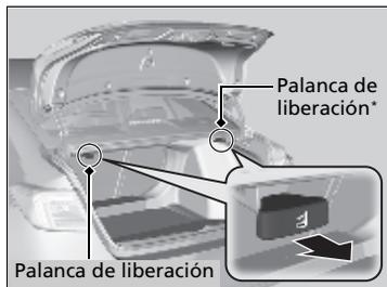
1. Tire de la palanca de liberación en el maletero para liberar el dispositivo de bloqueo.
