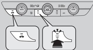
Al pulsar el botón
