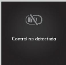
Cuando el modo de alimentación está en cualquier modo que no sea APAGADO y retira el control a distancia sin llave del vehículo y cierra la puerta, suena una alarma. Si sigue sonando la alarma, coloque el control a distancia sin llave en otro sitio.
