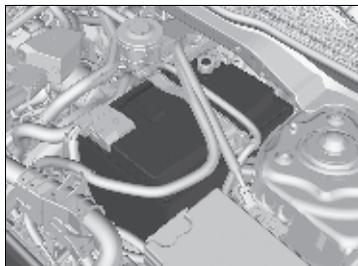
El estado de la batería se controla con un sensor ubicado en el borne negativo de la batería. Si se produce algún problema con este sensor, la interfaz de información del conductor mostrará un mensaje de advertencia. Si ocurre esto, haga que revisen el vehículo en un concesionario.
