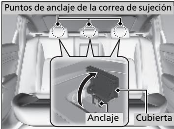
Hay un punto de anclaje para la correa detrás de cada asiento trasero. Si dispone de un sistema de sujeción infantil que incluye una correa de sujeción pero que se puede instalar con cinturón de seguridad, se puede utilizar la correa para mayor seguridad.
