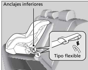
3. Coloque el sistema de sujeción para niños en el asiento del vehículo y, a continuación, fíjelo a los anclajes inferiores según las instrucciones del sistema de sujeción para niños.
