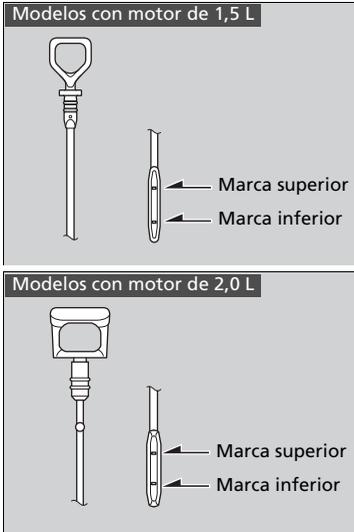
4. Retire de nuevo la varilla de medición del nivel y compruebe el nivel. Debería encontrarse entre las marcas superior e inferior. Añada aceite según sea necesario.
