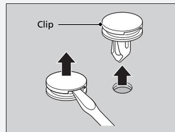
Introduzca el clip con el pasador levantado y empuje hasta que quede plano.
