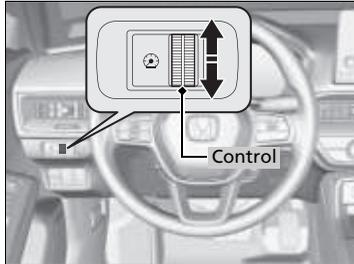
Cuando el modo de alimentación está en CONTACTO, puede usar el control de control de brillo para ajustar el brillo del panel de instrumentos.
