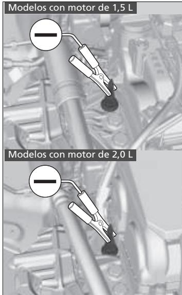
5. Conecte el otro extremo del segundo cable de arranque con pinzas al perno del vástago, como se muestra. No conecte este cable de arranque a ninguna otra parte.
