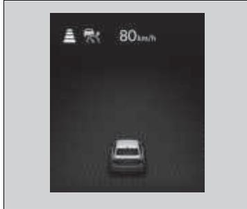
El vehículo mantiene la velocidad programada sin que haga falta tener pisado el pedal del freno o del acelerador.
