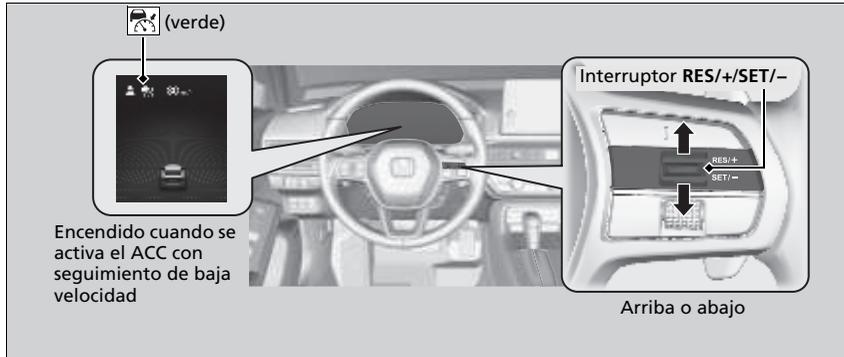
**Al conducir a 40 km/h o más:** Levante el pie del pedal y pulse el interruptor **RES/+ / SET/-** hacia arriba o abajo cuando alcance la velocidad deseada. En el momento en que suelte el interruptor, la velocidad programada quedará fija y se iniciará el ACC con seguimiento de baja velocidad.
