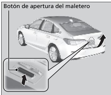
Empuje hacia arriba el botón de apertura en la tapa del maletero después de desbloquear las puertas.
