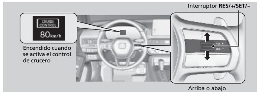
Levante el pie del pedal y pulse el interruptor **RES/+ / SET/-** hacia arriba o abajo cuando alcance la velocidad deseada.
