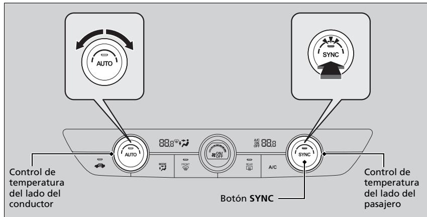
Es posible ajustar la temperatura a la vez para el lado del conductor y del pasajero en modo sincronizado.
