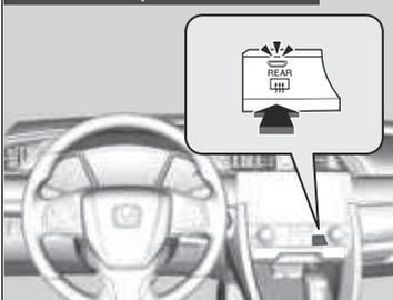
El desempañador trasero se desconecta automáticamente al cabo de 10-30 minutos, dependiendo de la temperatura exterior. Sin embargo, si la temperatura exterior es de 0°C o inferior, no se desconecta automáticamente.
