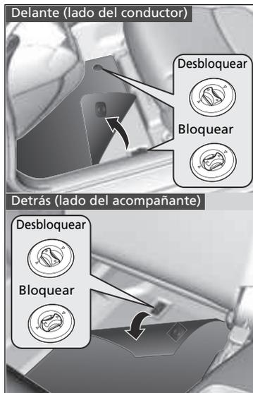
Las alfombras del piso del conductor y del pasajero trasero en el lado del acompañante quedan enganchadas por encima de los anclajes del piso, lo que impide que se deslicen hacia adelante. Para desmontar una alfombra para limpiarla, gire los control del anclaje a la posición de desbloqueo. Cuando vuelva a montar la alfombra después de limpiarla, gire los controles a la posición de bloqueo.
