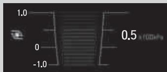
Cuando se activa el turbo intercambiador, este medidor muestra la sobrepresión.
