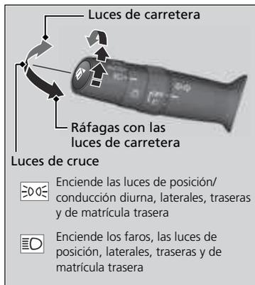
Al girar el interruptor de luces se encienden y apagan las luces, con independencia del ajuste de la modalidad de alimentación.
