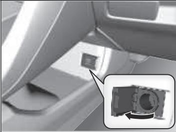
Hay una toma de alimentación de accesorios en el panel de la consola delantera. Se puede utilizar cuando la modalidad de alimentación está en ACCESORIOS o en CONTACTO.
