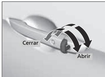
**Para abrir\*:** Desbloquee la puerta del conductor con la llave. Antes de que transcurran 10 segundos desde que la llave se colocó de nuevo en la posición central, gire la llave en el sentido de desbloqueo y manténgala en esa posición.
