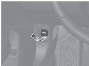
**2** Localice la palanca del cerrojo del cofre, tire de ella y levante el cofre. Una vez levantado el cofre ligeramente, puede soltar la palanca.
