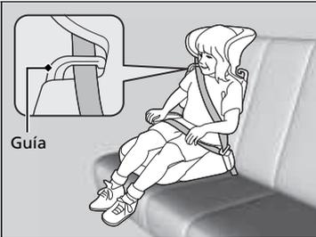
Hay disponible un respaldo para un asiento elevador determinado. Instale el respaldo en el asiento elevador y ajústelo al asiento del vehículo siguiendo las instrucciones del fabricante del asiento elevador. Asegúrese de que el cinturón de seguridad se pasa correctamente a través de la guía del hombro del respaldo y que el cinturón no toca ni cruza el cuello del niño.
