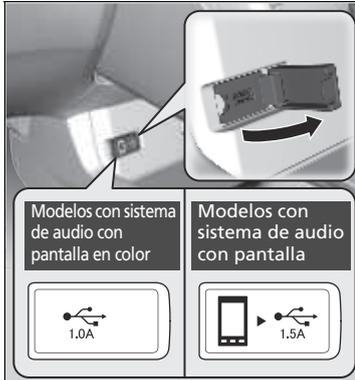
Coloque el conector USB del iPod o la unidad de memoria USB en el puerto USB.
