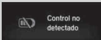
Los avisos acústicos de advertencia pueden sonar dentro y/o fuera del vehículo para recordarle que el control a distancia de acceso sin llave se encuentra fuera del vehículo. Si el aviso acústico continúa incluso después de introducir el control a distancia en el vehículo, coloque el control dentro de su alcance de funcionamiento.
