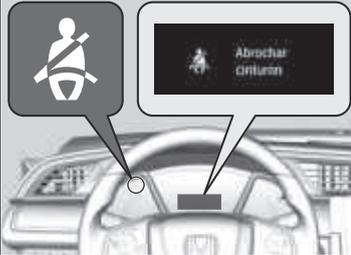
El sistema del cinturón de seguridad incluye un testigo en el tablero de instrumentos para recordar al conductor, al acompañante o a ambos que deben abrocharse los cinturones.
