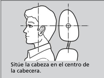
Las cabeceras delanteras resultan más efectivos para evitar el llamado efecto latigazo y otras lesiones por impacto trasero cuando la parte central posterior de la cabeza del ocupante está a la altura del centro de la cabecera. La parte superior de las orejas del ocupante debe quedar a la altura del centro de la cabecera.
