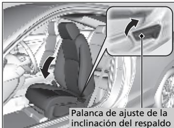
Palanca de ajuste de la inclinación del respaldo
