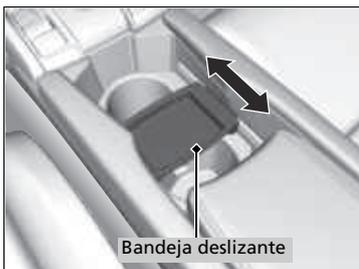
Puede poner pequeños elementos en la bandeja deslizante situada en la tapa del compartimento de la consola. Deslice la bandeja deslizante hacia delante o hacia atrás.
