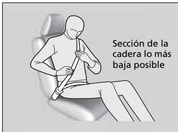
3. Coloque la sección de la cadera del cinturón de seguridad lo más baja posible sobre las caderas, y luego tire hacia arriba de la sección del hombro para que la sección de la cadera quede bien ajustada. De este modo, los robustos huesos pélvicos recibirán la fuerza del impacto, lo que reduce el riesgo de lesiones internas.
