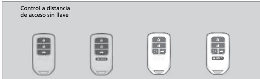
Utilice las llaves para arrancar y parar el motor, así como para bloquear y desbloquear todas las puertas, el maletero y la tapa del depósito de combustible. También puede usar el transmisor a distancia o el sistema de acceso sin llaves para bloquear y desbloquear todas las puertas, el maletero y la tapa del depósito de combustible.
