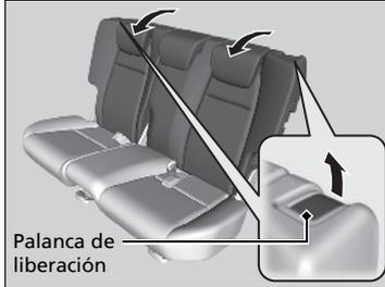
Tire de la palanca de la derecha para cambiar el ángulo de la mitad derecha del respaldo del asiento y de la palanca de la izquierda para la mitad izquierda.
