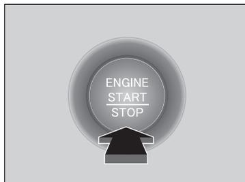
3. Oprima el botón **ENGINE START/STOP** sin pisar el pedal del acelerador.
