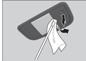
1. Haga palanca en el borde de la tapa con un desarmador de punta plana para desmontarla.
