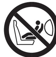
No utilice un sistema de sujeción para niños orientado hacia atrás en un asiento protegido por un airbag frontal.
