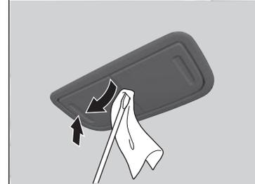
1. Presione el cristal del lado opuesto a la bombilla que va a sustituir.
