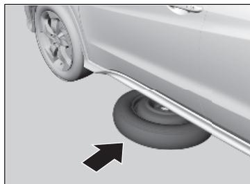
6. Coloque la rueda de repuesto compacta (con la llanta hacia arriba) debajo del vehículo, cerca del neumático que va a sustituir.
