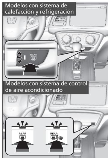
Pulse el botón de la luneta térmica o toque el icono para desempañar la luneta y el retrovisor\* con el interruptor de encendido en la posición de CONTACTO \*1.
