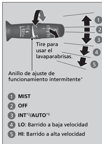
El limpia/lavaparabrisas se puede utilizar cuando el interruptor de encendido está en la posición de CONTACTO [III]\*<sup>1</sup>.
